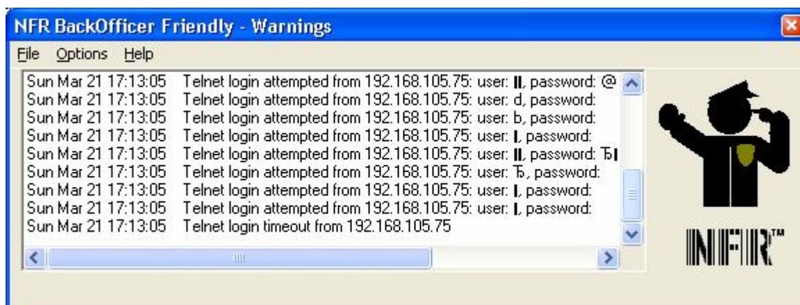
Рисунок 56. NFR BackOfficer Friendly, эмулирующий работу TELNET-сервера, оповещает о процессе подбора злоумышленником (IP-адрес 192.168.105.75) паролей к ложному серверу.
